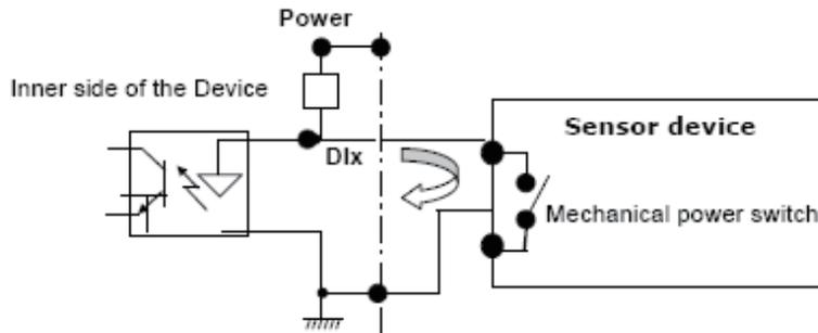
Relay wiring diagram 1
